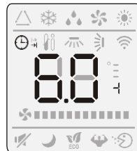
1 pav. Laikmatis įjungtas, kai jungtukas išjungtas
